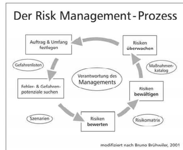
Abb. 9: Der Risk Management – Prozess, modifiziert nach Brühwiler
